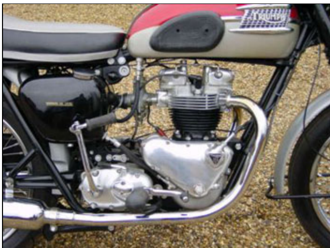
Bemærk den særlige tankmontering, på alle 1960-1962 pre Unit's tanker står på 3 gummi og holdes nede med et bånd hængt over tanken.
