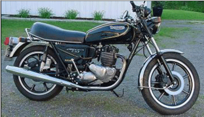
1982: TSS (T140W) 8 ventilet topstykke elstart, kraftigere kobling Kraftigere bagsvinger. 1/4" tykkere krumtapsøler. kraftigere oliepumpe (4 ventilet) Dobbelte Brembro skiver.
